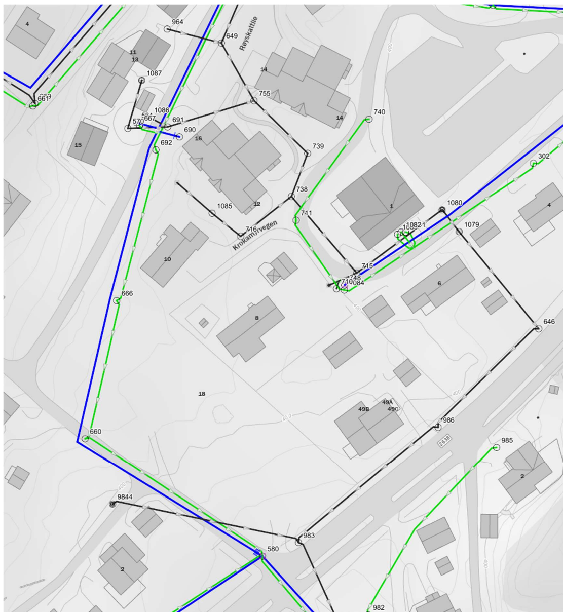
Figur 3. Kart som viser det kommunale avlaupsnettet. Svarte liner viser kommunalt nett for overvatn. Blå liner viser kommunalt vassleidningsnett, medan grøne liner viser avlaupsnettet. Overvassnettet i dette området har vore oppgradert i det siste (etter uveret Hans i 2023). Kommunen sitt VA-kart i figur 3 er ikkje oppdatert i forhold til dette arbeidet.
