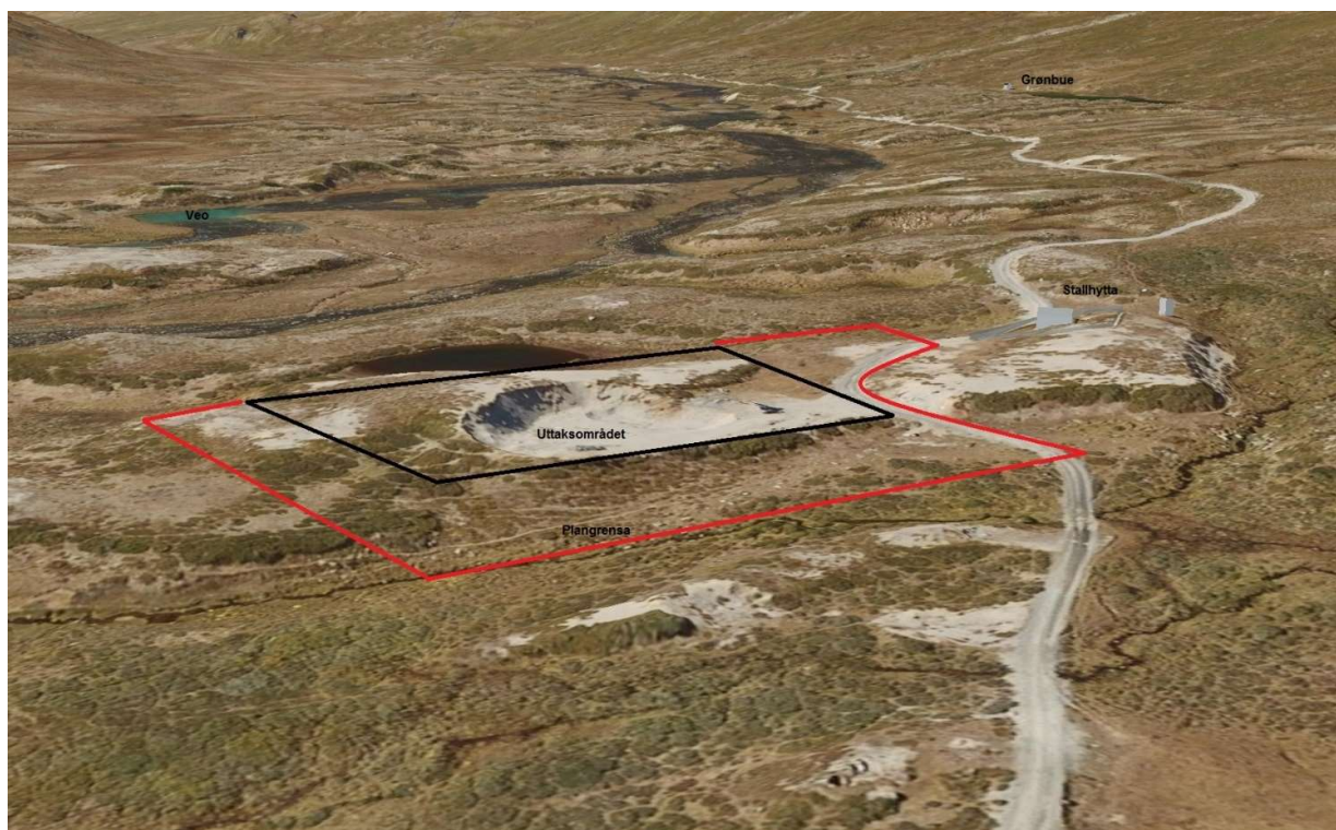
Figur 8: Planområdet og uttaksområdet plassert i ein 3D-modell sett mot vest innover Veodalsvegen. Plangrensa er vist med raud strek, og regulert uttaksområde med svart strek.
