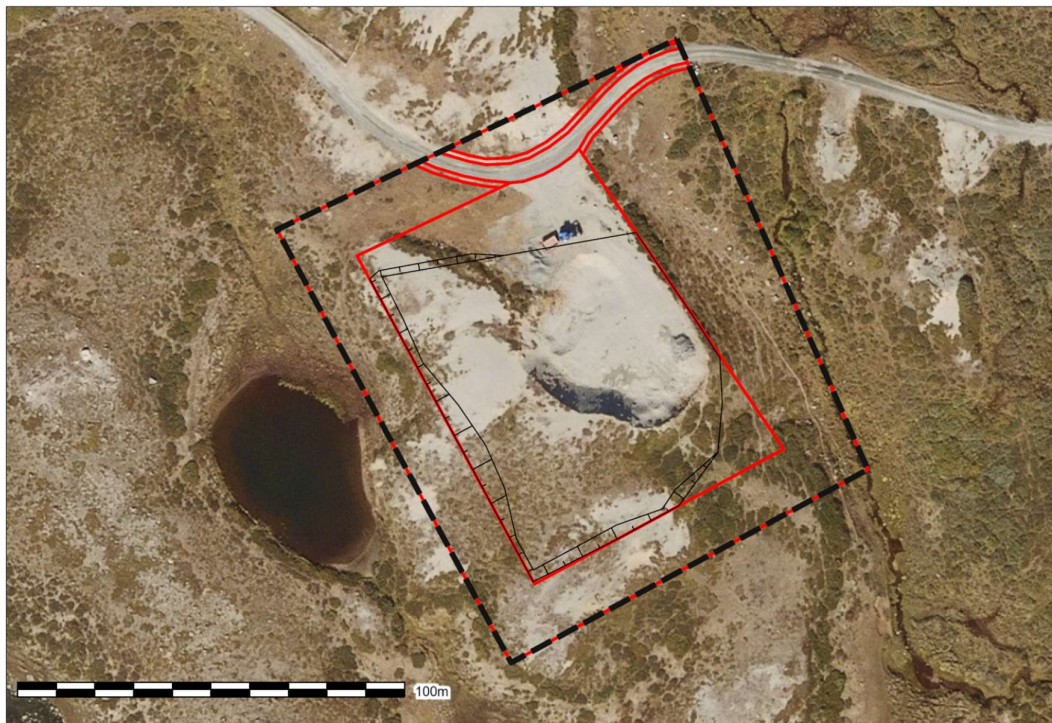
Figur 5: Avgrensinga av planområdet og regulert uttaksområde med skråningsutslag ved avslutting av uttaket. Plangrensa er vist med svart stipla strek, og arealformålsgrenser med raud strek, og markering av terrengutslag og markering av planlagt botn av uttaket med svarte tynne strekar. Bakgrunn er flyfoto frå 2017.
