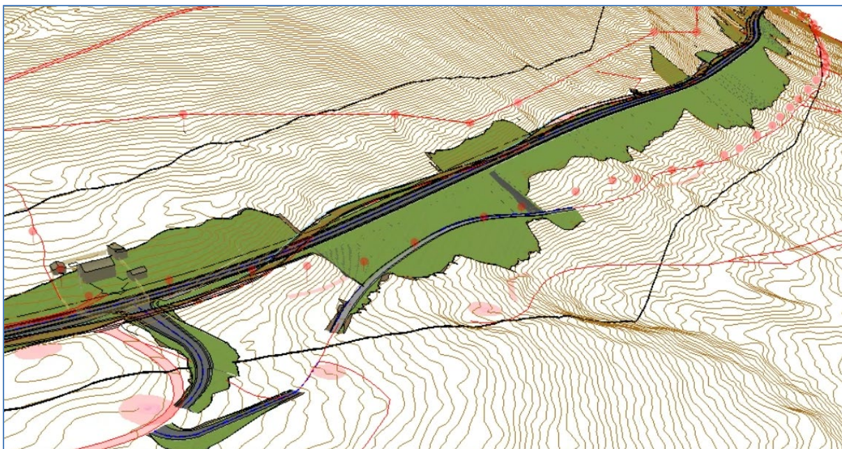
Figur 7-24 Utfylling langs Rådsbakken og vestover vil råke eldre veg. Dei rosa prikkane markerer vegraseen. Ny veg etablerast i fyllinga for å sikre bruken, og resten av vegen vert angitt med omsynssone H570.
