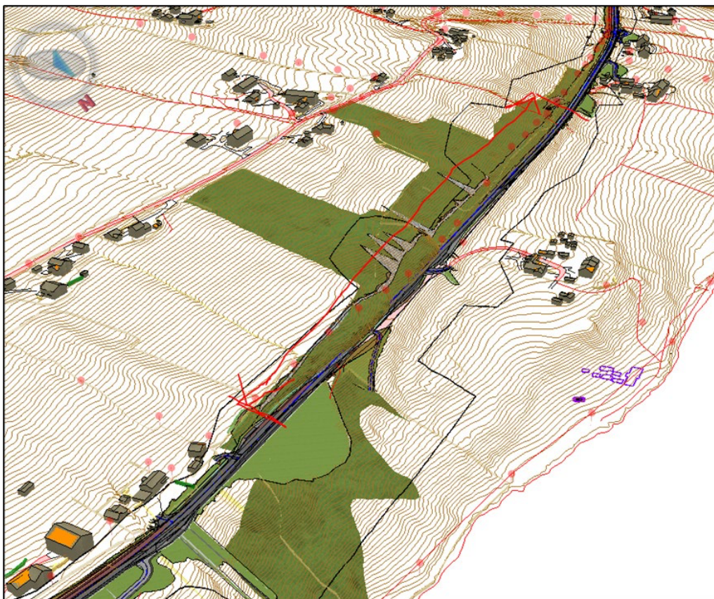
Figur 7-10 Breiddeutvidinga blir teken mot sør, noko som resulterer i tap av beitemark og høgare fjellskjeringar enn i dag. Grønt felt er Beitemark, raud markering viser lengd på ny fjellskjering. (Kjelde: Statens vegvesen)
