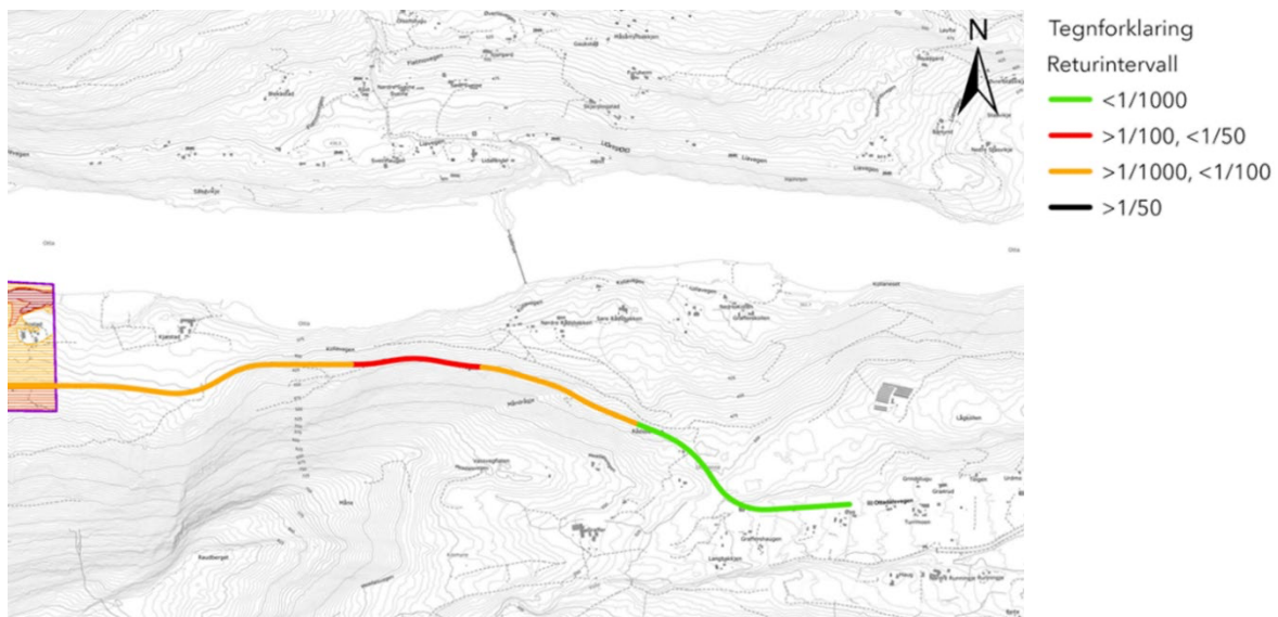
Figur 8-1: Returintervall for skred med tilhøyrande tryggleiksklasser aust i planområdet, etter TEK17 og N200. Kjelde: Asplan Viak
