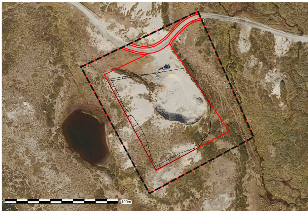
Figur 5: Avgrensinga av planområdet og regulert uttaksområde med skråningsutslag ved avslutting av uttaket. Plangrensa er vist med svart stipla strek, og arealformålsgrenser med raud strek, og markering av terrengutslog og markering av planlagt botn av uttaket med svarte tynne strekar. Bakgrunn er flyfoto frå 2017.
