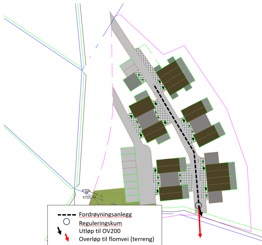
Figur 14 – Forslag til prinsippløsning for fordøyningsanlegg
